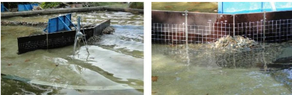
Рис. 10. Серия 3. Сооружение с волногасящим откосом в средней части. Вид модели во время (слева) и по окончании (справа) опытов (иллюстрация авторов)
