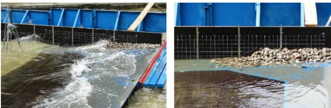
Рис. 7. Серия 2. ГТС с волногасящим откосом в корневой части. Вид модели во время (слева) и по окончании (справа) опытов (иллюстрация авторов)
